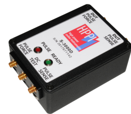
(d) 18 GHz DUT switch S-3000D
