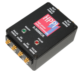
(c) 18 GHz DUT switch
